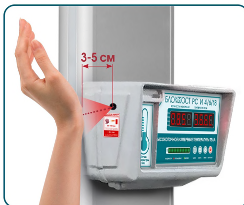
Бесконтактное измерение температуры тела с запястья руки
